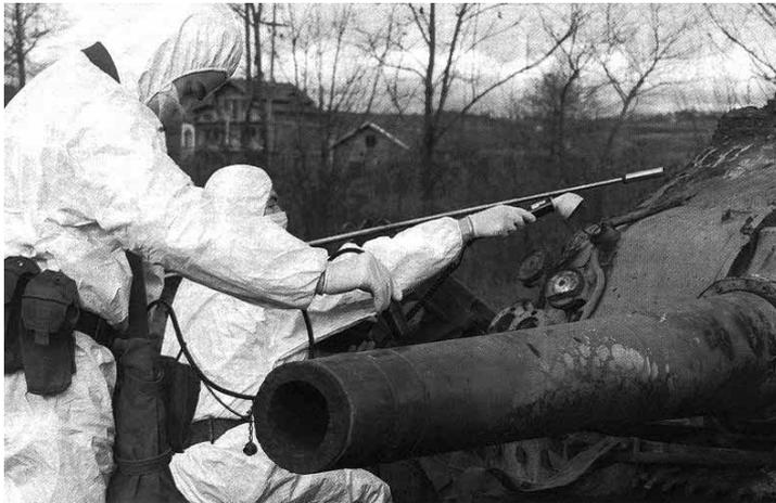
Des soldats de la KFOR au Kosovo mesurent le niveau de rayonnement d'un char détruit à l'aide de munitions à l'uranium appauvri.
