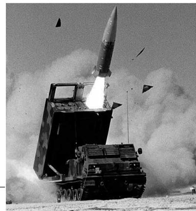
Le système MLRS lance un missile de type ATACMS Block 1, composé de 950 sous-munitions (Lockheed Martin)
