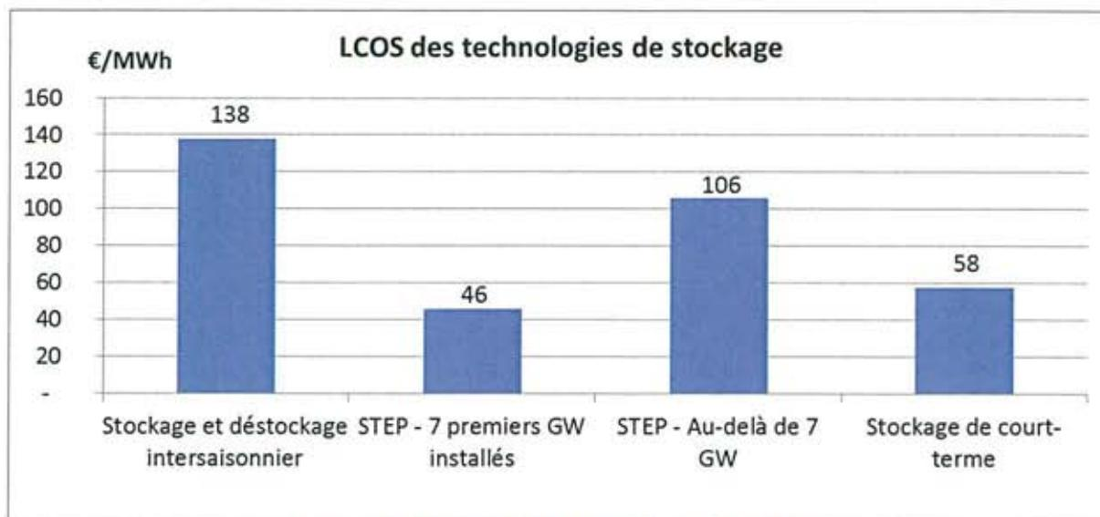
Figure 11 - Comparaison des LCOS des différents stockages
