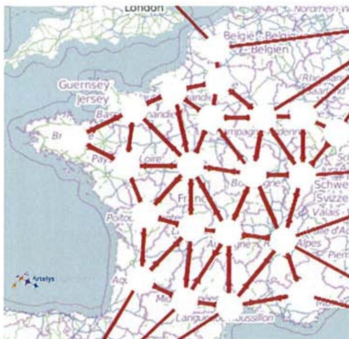
Figure 36 - Carte du réseau interrégional ; la capacité d'échange commercial de chaque segment, hormis les interconnexions avec l'étranger, fait l'objet d'une optimisation
