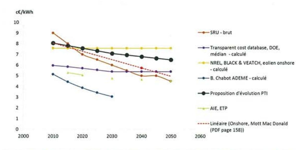
Figure 6 - Evolution du coût de la filière éolienne terrestre (pour un facteur de charge moyen de 25%)
