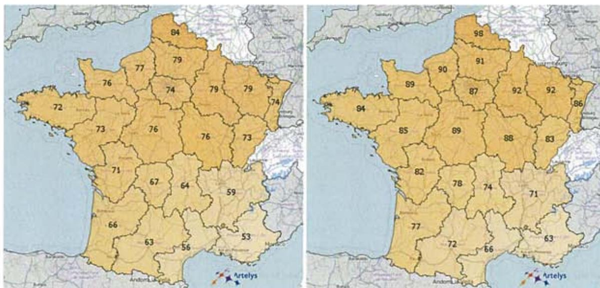
Figure 8 - LCOE par région (€/MWh) des filières PV (au sol à gauche, sur toitures à droite)
