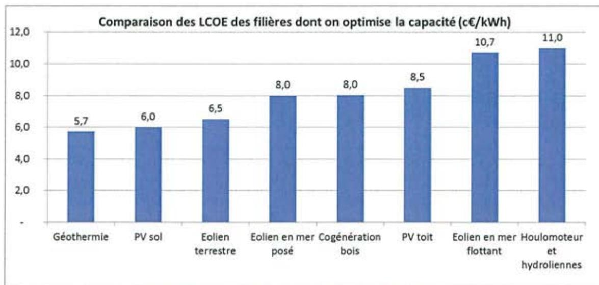
Figure 7 - Comparaison des coûts technologiques projetés à 2050
