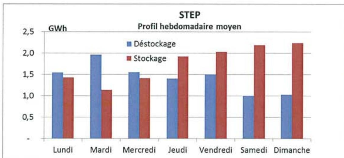
Figure 31 - Profils hebdomadaires moyens de stockage (en rouge) et déstockage (en bleu) des STEP (valeurs nationales)
