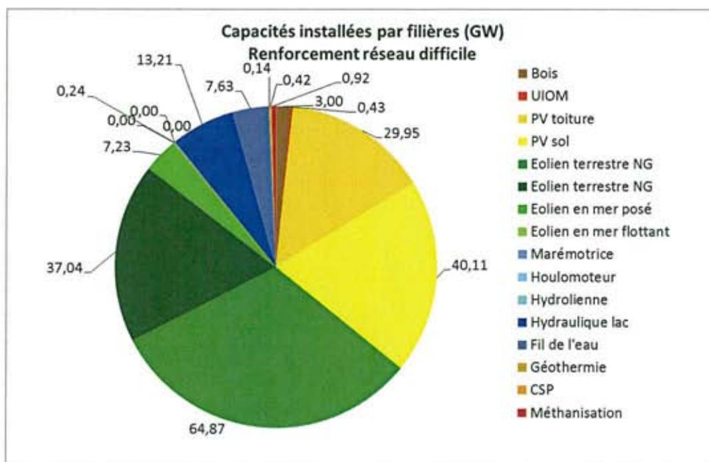
Figure 48 - Capacités installées par filière – cas du renforcement réseau difficile
