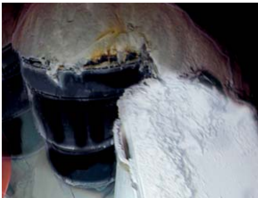
FÉVRIER 2014, CENTRE DE STOCKAGE DU WIPP, LE FÛT 68660 LAISSE ÉCHAPPER DES MATIÈRES RADIOACTIVES
