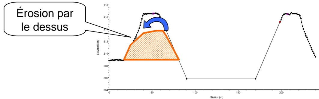
Mode de rupture **peu probable** du fait de la présence de **déversoirs de sécurité** sur le bief
