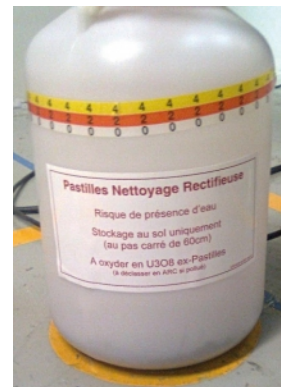
Étiquette d'un bouteillon contenant des rebuts issus des rectifieuses potentiellement humides muni de son étiquette spécifique
